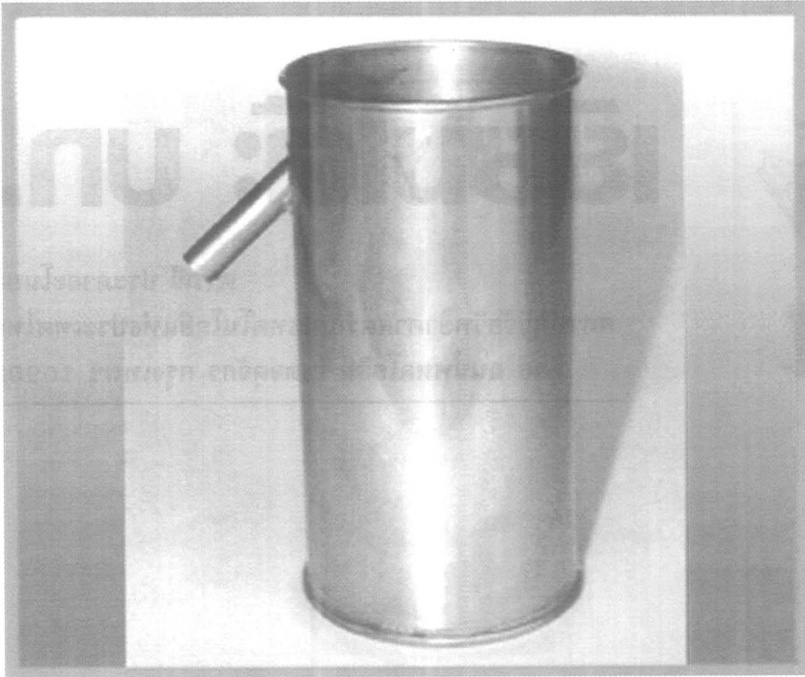
ถ้วยยูเรก้า เป็นถ้วยทรงกระบอกที่ทำด้วยสแตนเลส มีท่อน้ำไหลทำด้วยสแตนเลสทำมุมเอียง 45 องศากับถ้วย ศูนย์กลางของท่อน้ำที่ติดกับตัวถ้วยสูงจากพื้น 10 เซนติเมตร
