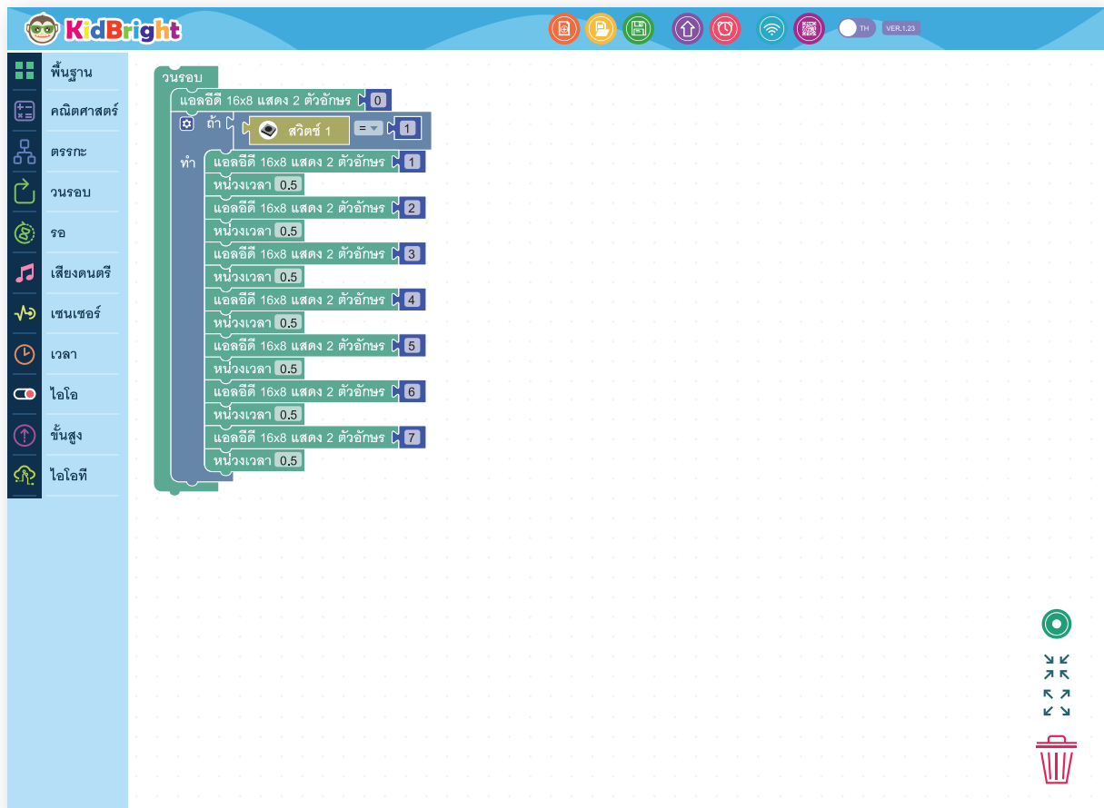
ภาพที่ 5.12 โปรแกรมแสดงตัวเลข 0-7 บนจอแสดงผลแอลอีดี 8x16 เมื่อมีการกดสวิตช์ 1
