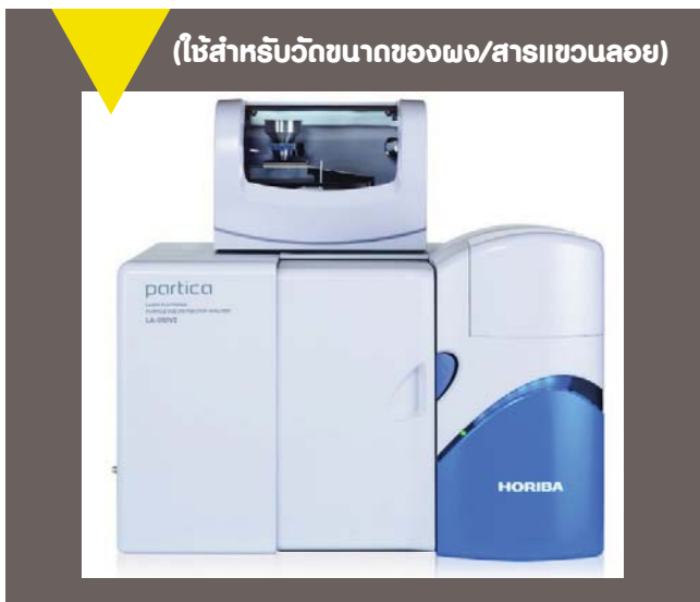
ภาพที่ 4 ตัวอย่างเครื่องวัดการกระจายตัวของขนาดอนุภาคด้วยเทคนิคการเลี้ยวเบนของแสงเลเซอร์ [4][5]
