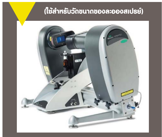
ภาพที่ 4 ตัวอย่างเครื่องวัดการกระจายตัวของขนาดอนุภาคด้วยเทคนิคการเลี้ยวเบนของแสงเลเซอร์ [4][5]
