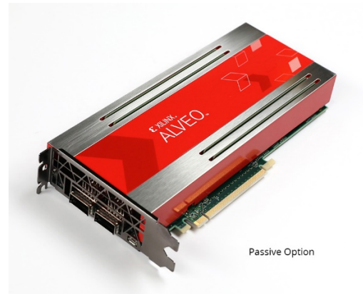
รูปที่ 13 การ์ด Xilinx Alveo U250 (Xilinx Inc.)
