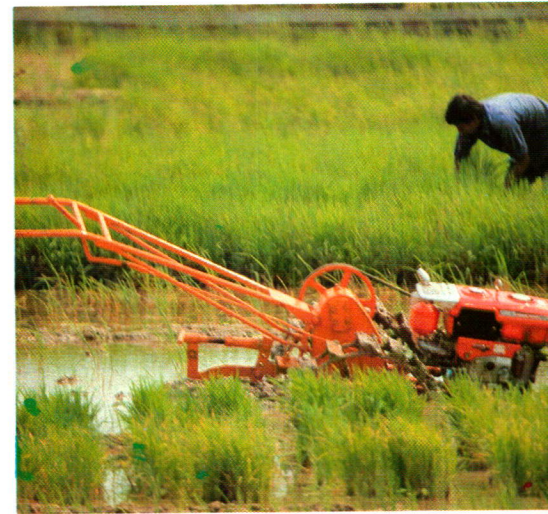
“อึดั้น” รถเอนกประสงค์ ใช้ไถนาก็ได้ แทนเครื่องสูบน้ำก็ได้ ฯลฯ
