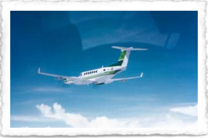
Das für physikalische Forschung ausgerüstete Flugzeug vom Typ SUPER KING AIR 350 im Einsatz zur „Bombardierung“ von Wolken.
