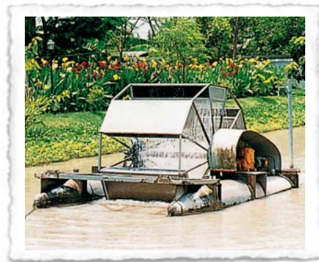
Ein Chaipattana Aerator, eine von Seiner Majestät König Bhumbol entwickelte schwimmende Schaufelrad-Konstruktion zur Gewässerreinigung.
