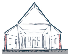
พระที่นั่งอิศราวินิจฉัย ผนังอาคารย้ายไปรับน้ำหนักชายคาปีกนก
