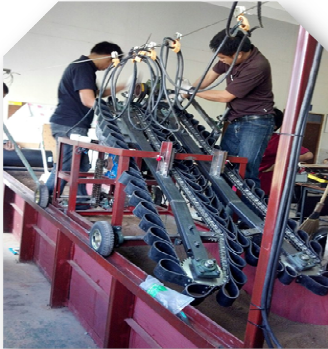
รูปการติดตั้งแผ่นยางบนโซ่ลำเลียงของเครื่องเก็บเกี่ยวมันสำปะหลังสำหรับรถแทรกเตอร์ขนาดเล็ก
