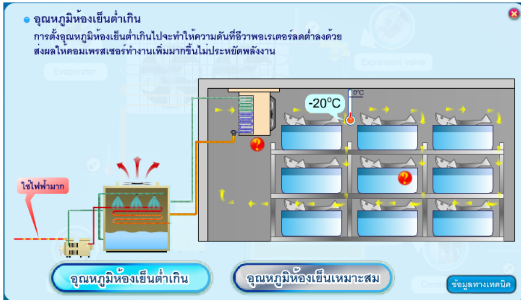
รูปที่ 3-20 อุปกรณ์อีวาพอเรเตอร์ เมื่อปรับอุณหภูมิห้องเย็นต่ำเกิน
