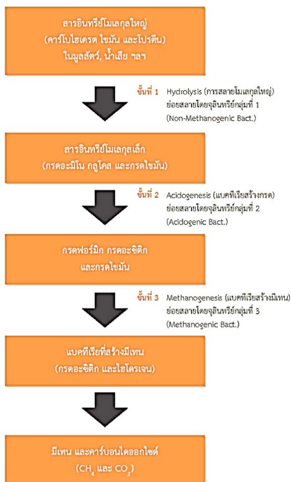
รูปที่ 14-4 กระบวนการผลิตก๊าซชีวภาพ
