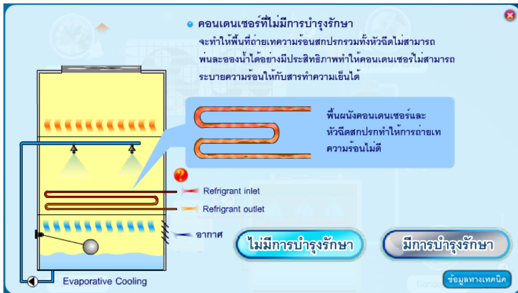
รูปที่ 3-24 การไม่มีการบำรุงรักษาอุปกรณ์คอนเดนเซอร์
