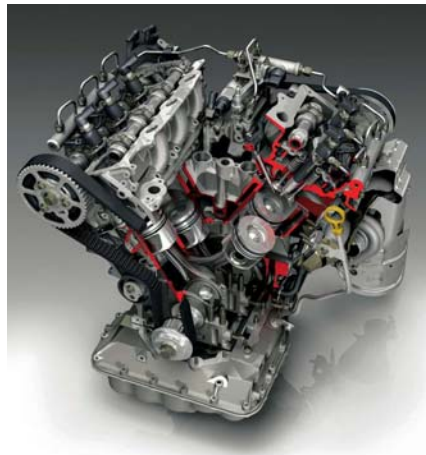
รูปที่ 2-10 เครื่องยนต์ดีเซล 4 จังหวะ
