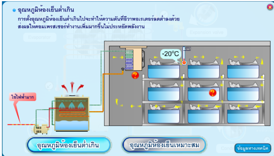
รูปที่ 3-20 อุปกรณ์อีวาพอเรเตอร์ เมื่อปรับอุณหภูมิห้องเย็นต่ำเกินไป
