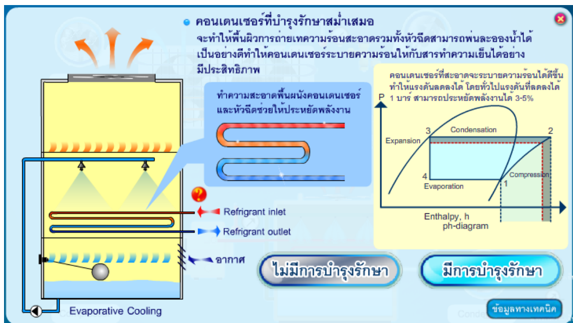
รูปที่ 3-25 การบำรุงรักษาอุปกรณ์คอนเดนเซอร์
