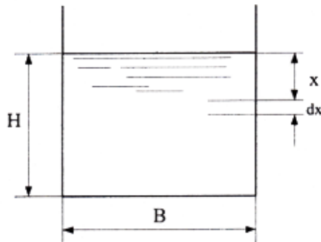
รูปที่ 11-4 ฝายแบบช่องน้ำล้นรูปสี่เหลี่ยมผืนผ้า
