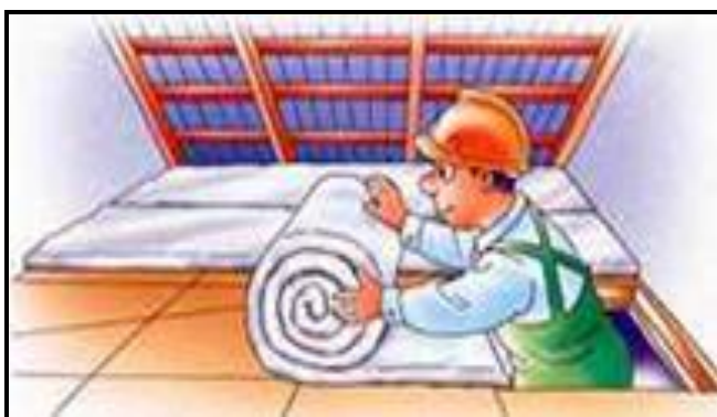
รูปที่ 13-31 แสดงแผ่นใยแก้วที่มีความหนา 1 นิ้ว ชนิดมีแผ่นฟอยล์
