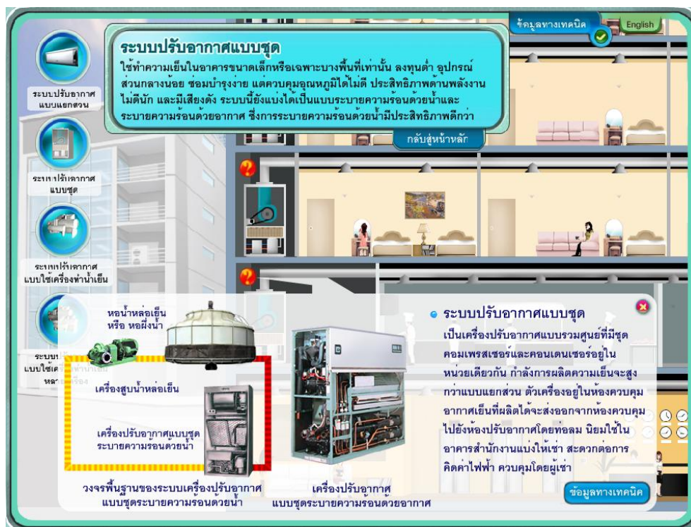
รูปที่ 13-9 ระบบปรับอากาศแบบชุด
