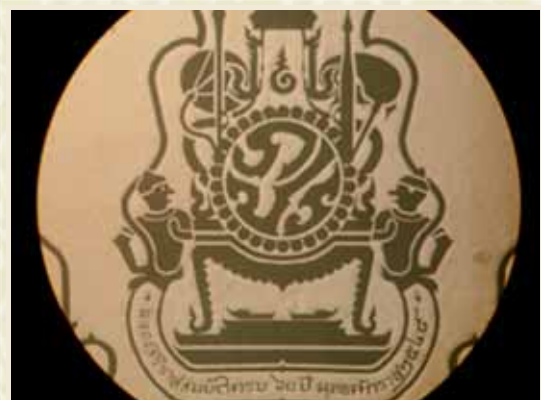
ภาพผ่านกล้องจุลทรรศน์ แสดงแม่พิมพ์พอลิเมอร์ บนแผ่นกราฟิ์
