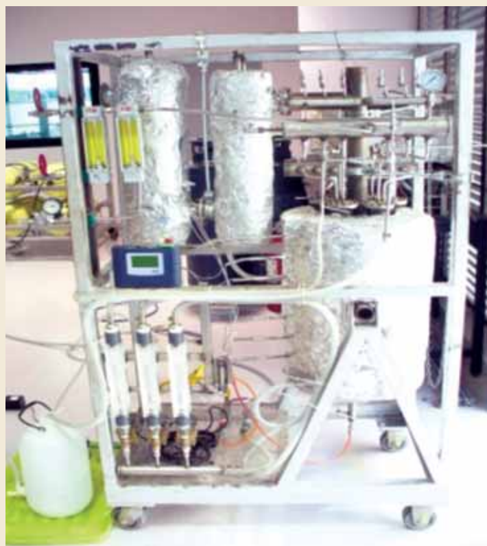
ชุดปฏิรูปก๊าซมีเทนจากก๊าซชีวภาพ เป็นก๊าซไฮโดรเจน
