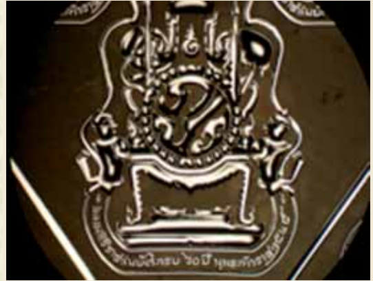
ภาพจากกล้องจุลทรรศน์แสดงโครงสร้างโลหะ निकเกิล ที่เคลือบในแม่พิมพ์พอลิเมอร์หนา
