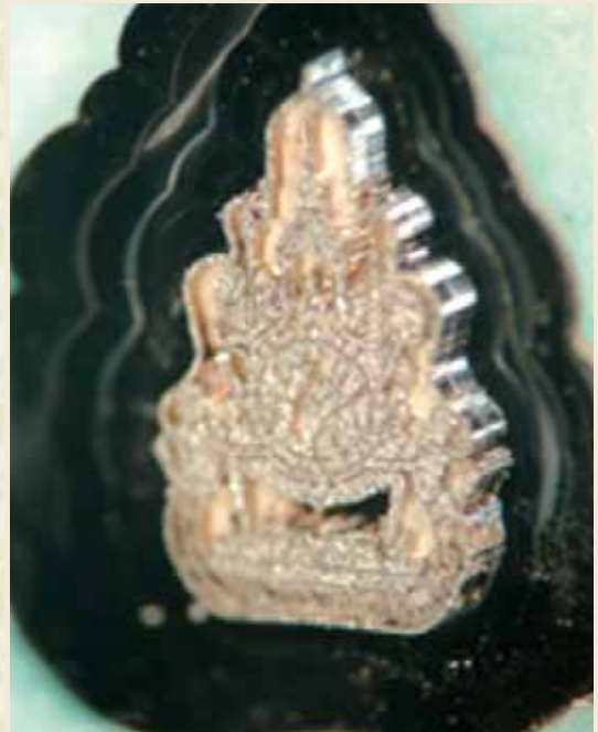
ภาพจากกล้องจุลทรรศน์แสดงตราสัญลักษณ์ บนแผ่นฐาน निकเกิลซึ่งแยกออกมาจากแผ่นสแตนเลสแล้ว
