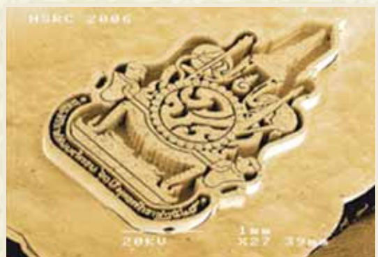
ภาพจากกล้องจุลทรรศน์อิเล็กทรอนิกส์ แสดงตราสัญลักษณ์บนแผ่นฐาน निकเกิลหลังชุบทอง
