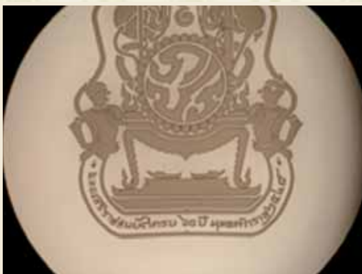
ภาพผ่านกล้องจุลทรรศน์ แสดงลวดลายที่บัสแสง อัลตราไวโอเลต ของตราสัญลักษณ์ บนกระจกต้นแบบ
