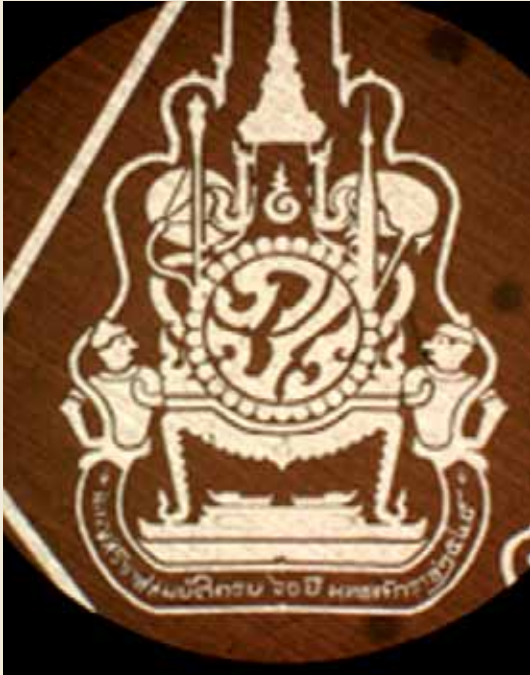
ภาพจากกล้องจุลทรรศน์ แสดงแม่พิมพ์พอลิเมอร์ หนาประมาณ 200 ไมโครเมตร บนแผ่นเหล็กสแตนเลส หลังจากการฉายแสงซินโครตรอนและล้างฟิล์ม
